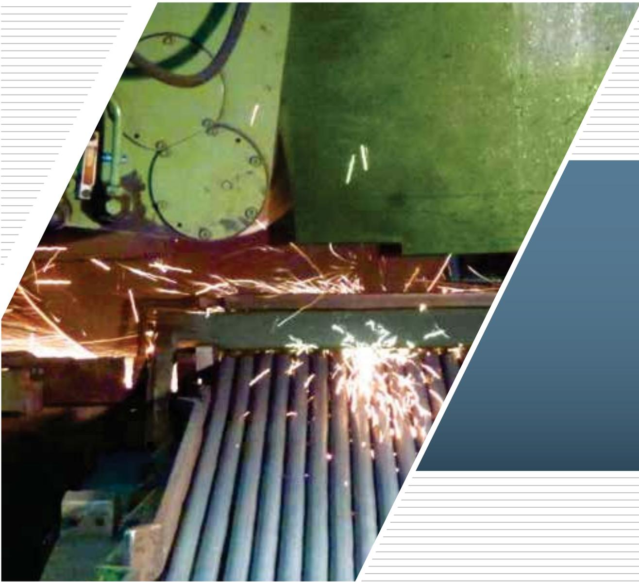
Das Trennen von Stahl erfordert verstärkte Hochleistungsscheiben, damit eine gute Qualität, ein sauberer Schnitt und eine effiziente Schnittrate erzielt werden kann. Saint-Gobain Abrasives bietet eine breite Palette an optimierten Trennschleifscheiben, die für jegliche Anforderungen, Schneidetemperaturen und Werkstoffeigenschaften perfekt geeignet sind. Großtrennscheiben (LDCO) haben einen Durchmesser von mehr als 900 mm und sind im Stahlmarkt weit verbreitet.
