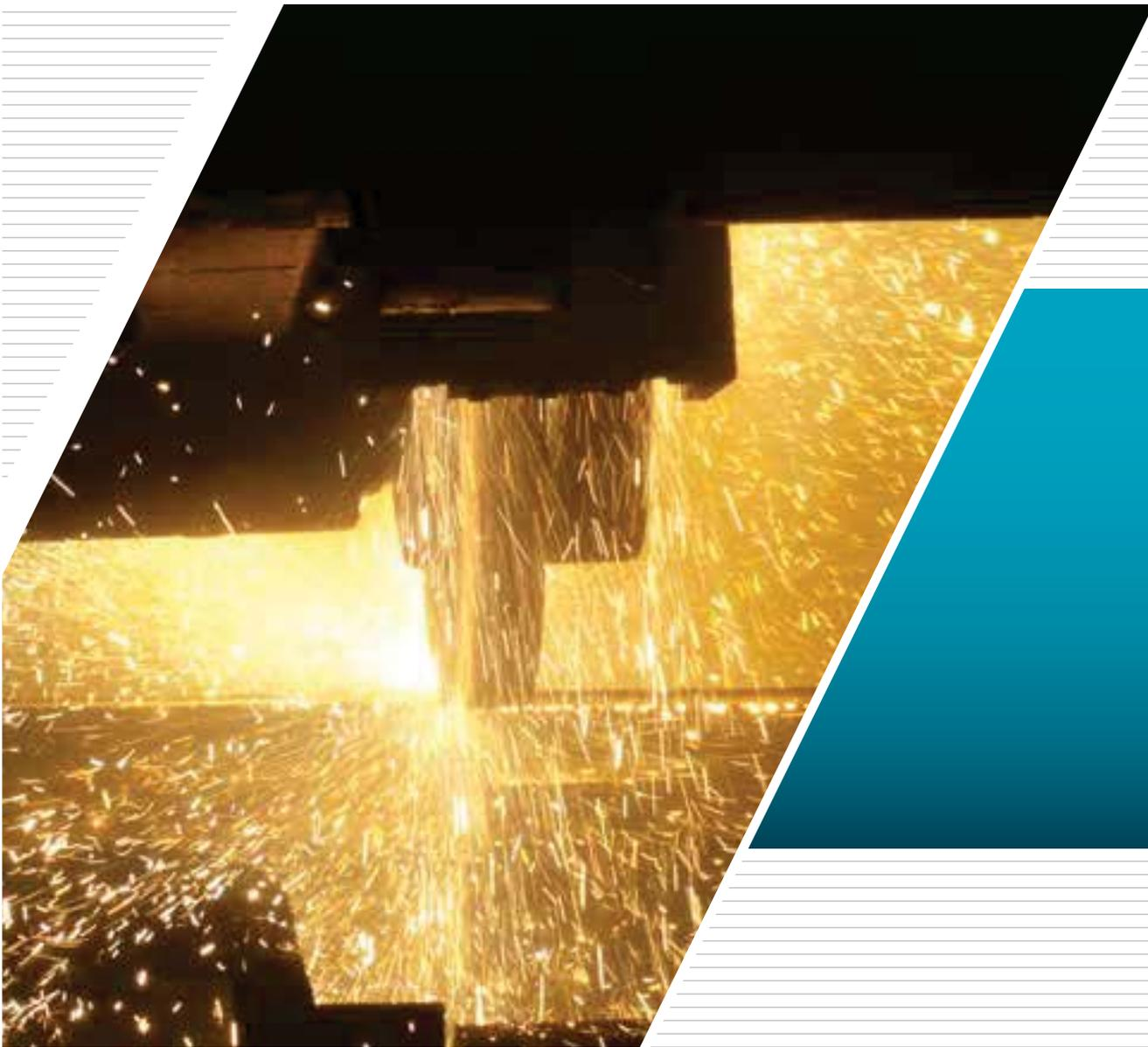
Bei Stahlbearbeitungsprozessen werden heißgepresste, sehr harte Schleifscheiben ohne poröse Oberfläche üblicherweise zur Beseitigung von Fehlern (Rissen, Unreinheiten und Brüchen) in Brammen, Vorblöcken, Barren und Blöcken verwendet.
